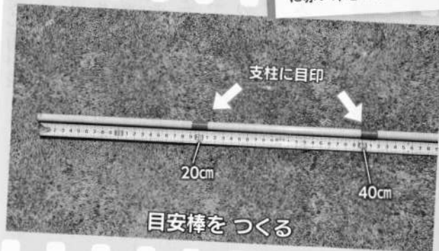
画像1 電気柵を設置する時に線の高さの基準となる「目安棒」。地面から20cmと40cmに赤い印をつけてある
