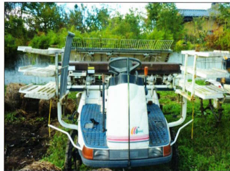
マット苗用ブローア付側条施肥田植機
